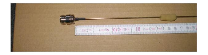
MEASURE THE LENGHT AT THE END OF THE ELEMENT, RIGHT NEXT TO THE END OF THE CONNECTOR, FIND AND MARK YOUR FREQUENCY ACCORDING THE CHART AND CUT THE EXCSES LENGHT WHILE THE METER IS TOUCHING THE CONNECTOR IN DESCRIBED WAY STEP BEFORE
