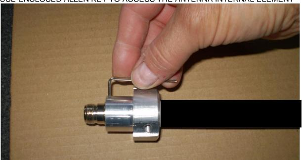
PULL THE INTERNAL STRUCTURE FROM THE ANTENNA
