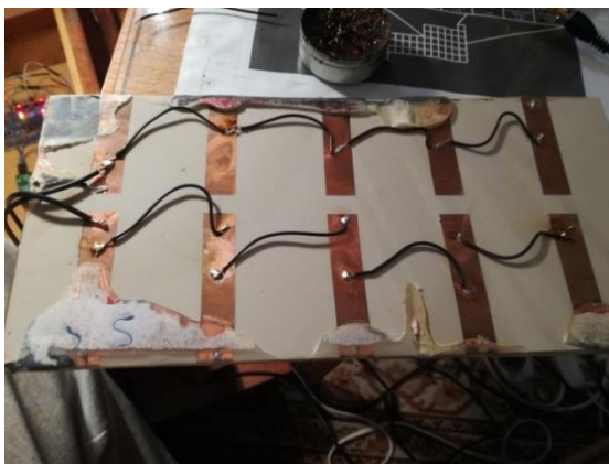
Obrázok 8 Zapojenie solárnych článkov
